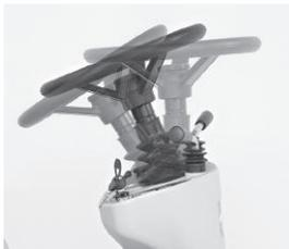
Con un volante ajustable y pedales de talón y punta del pie para control direccional, la barredora de operador sentado brinda una operación ergonómica y segura.
