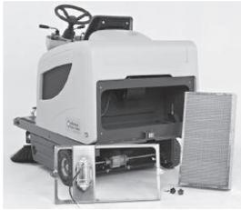
Un filtro para polvo que no requiere herramientas contiene un sistema de desvío para filtrar las partículas de mayor tamaño y alargar la vida del filtro de panel. Una tolva grande para basura, de cuatro lados, en acero incluye ruedas para transporte para facilidad de uso y seguridad del operador.
