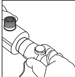
**Paso 10:** El equipo de esterilización debe estar colocado lo más cerca posible al punto de uso y puede ser utilizado en forma vertical u horizontal. Asegúrese que la salida de agua siempre esté por la parte superior.
