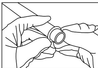
**Paso 5:** Coloque la manga de cuarzo dentro de la cámara de acero inoxidable.
