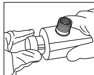
**Paso 7:** Conecte el foco emisor UV de 4 pins a la balasta electrónica.
