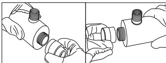
**Paso 4:** Instale el O-ring en la tapa abierta de la manga de cuarzo (12mm de la orilla).
