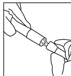
**Paso 8:** Cuidadosamente inserte el foco emisor UV dentro de la manga de cuarzo a través de la tapa abierta.
