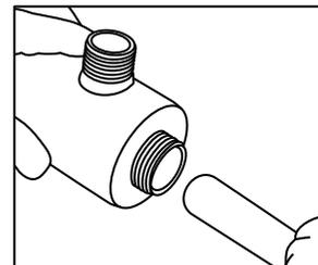
**Paso 6:** Atornille la tapa de la cámara de acero inoxidable. Evite apretar mucho la tapa para no dañar el O-ring o la manga de cuarzo.
